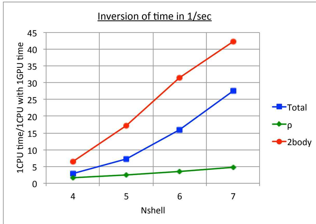
→ Hamiltonian行列要素計算にかかるelapsed timeの逆数をGPUとCPU 1 threadで比較(GPU+CPU 1thread/CPU 1thread)
