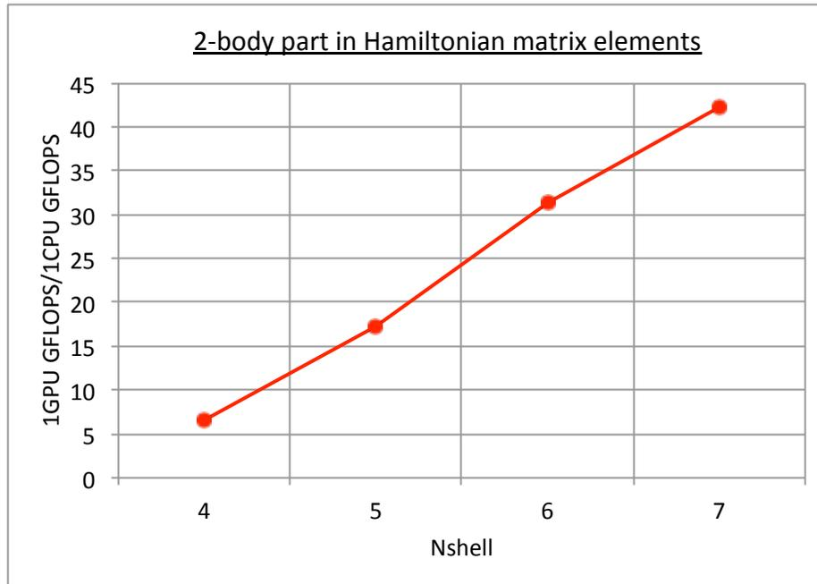
→ 2体相互作用部分についてFlops数をGPUとCPU 1 threadで比較(GPU/CPU 1thread)
